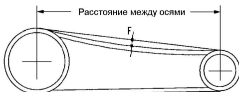
Рис.10 Регулировка натяжения ремней
